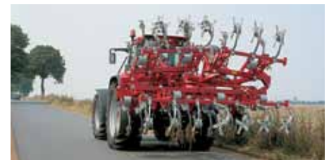
VF 4200 / 4300 / 4000 Flat folding side extensions.
