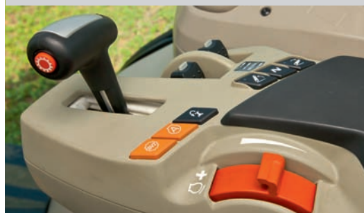
Schimbătorul în T al transmisiei Dyna-6 pentru schimbarea treptelor semi-powershift și a gamelor.
