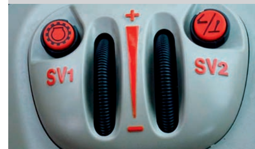
Modulul de control al transmisiei poate fi utilizat pentru a varia strategia de condus în orice moment – chiar și în timpul deplasării sau sub încărcătură.
